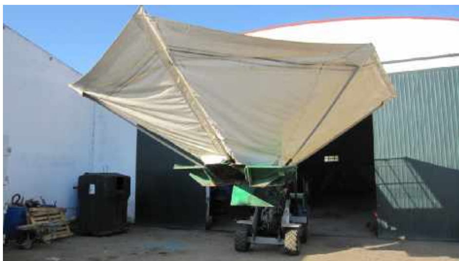
Foto 1: Maskine til høst af oliven
