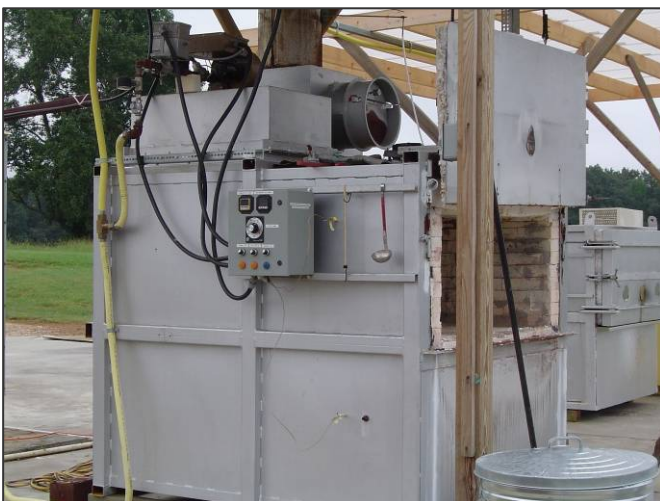
Billedtekst: Forgasser til afbrænding af døde grise.
