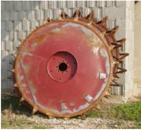
Jernhjul, som monteres på traktoren ved arbejde i de våde rismarker
